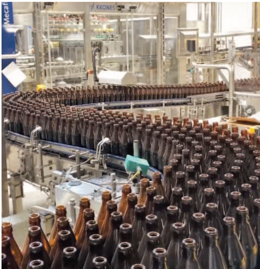
Die Abfüllanlage im neuen Werk schafft 10.000 Flaschen pro Stunde (Bild Giesinger Bräu)
